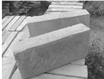
**LADRILLOS PRENSADOS (DE MAQUINA):**
