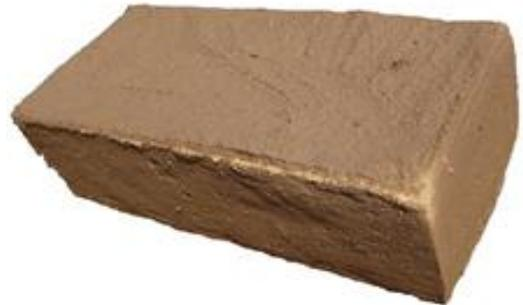
**LADRILLO COMÚN:** Se realiza con tierra arcillosa y material orgánico más agua, formándose una masa homogénea y moldeable, una vez desamoldado es secado a la sombra. Terminado el proceso de secado son sometidos a la acción del fuego en hornos industriales o bien contruados con los mismos ladrillos. Dispuestos en forma de pirámide dejando en su interior un lugar para el combustible.
