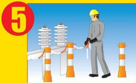
5 Delimitar y señalar la zona de trabajo
