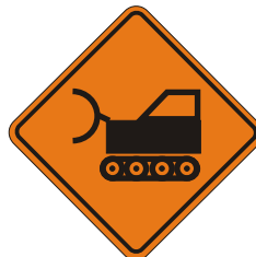
Equipo Pesado en la Vía T 7
