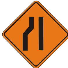
Estrechamiento de Calzada T 4
